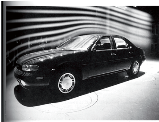
Сл. 7.16. Ламинарно струење околу автомобил при неговото тестирање во аеродинамички тунел
