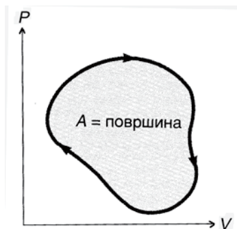
Сл. 9.5. pV -дијаграм за затворен кружен процес кај топлинска машина. Вкупната работа што ја врши машината во текот на еден циклус е еднаква на површината затворена од кривата
